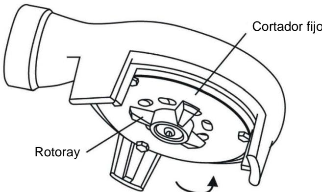
En la entrada de la bomba está integrada una cuchilla giratoria de alta velocidad, de este modo se cortan las fibras largas y residuos sólidos presentes en las aguas residuales. Este diseño ayuda a evitar que el impulsor se enrede y se bloquee.
